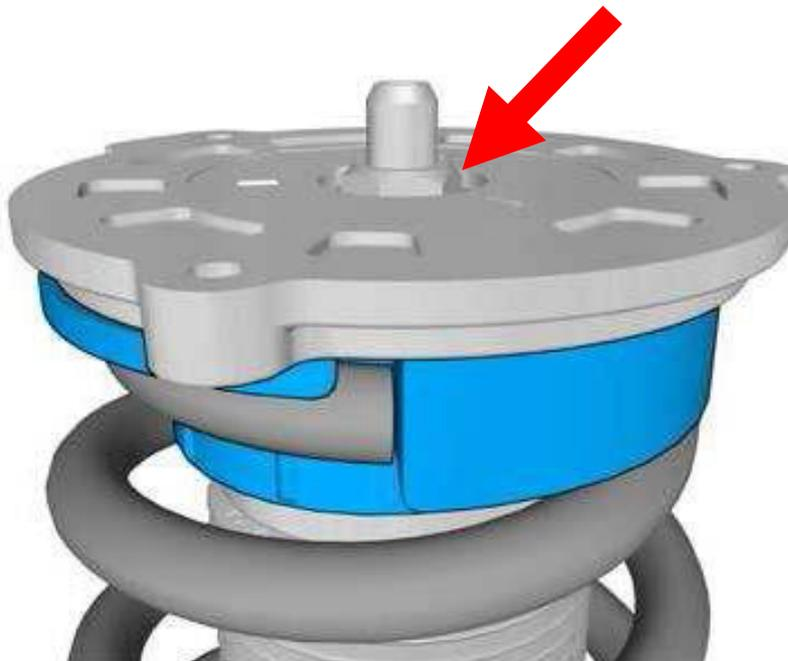
**Die Mutter gegen eine neue Mutter ersetzen! *Replace the nut against a new one!***
