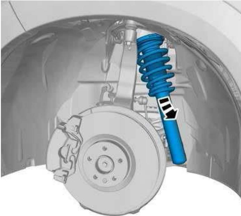
**8. Die Feder mit dem Spezialwerkzeug vorspannen / Pre stress the spring with the special tool**
