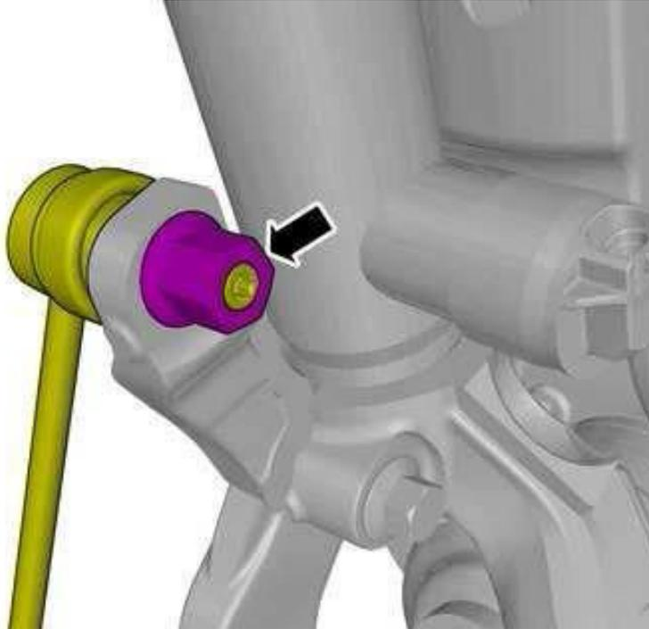
**4. Die Stabilisatorstange nach hinten weg bewegen und die Schraube entfernen / Push the stabilizer rod backwards and remove the screw**
