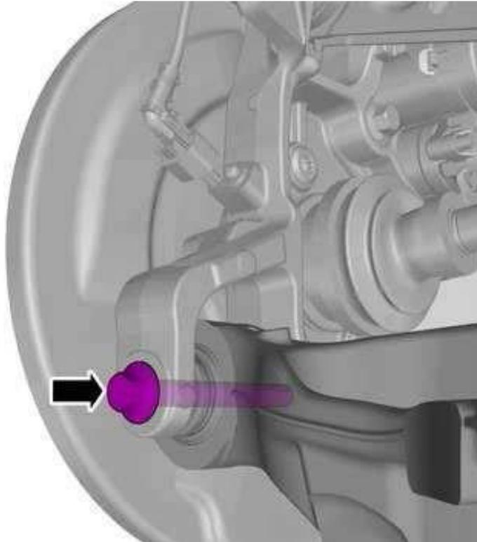
**27. Die Mutter entfernen / Remove this nut**
