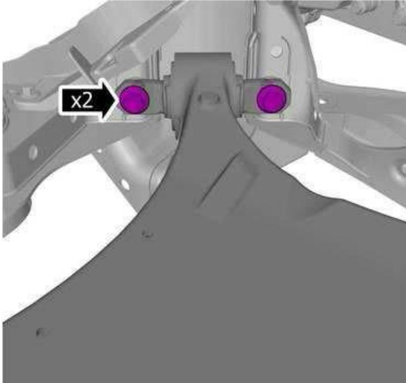
**25. Schraube entfernen / Remove screw**
