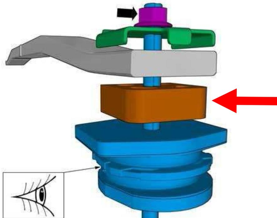
31. Montieren Sie nun die Hinterachse in umgekehrter Reihenfolge. Achten Sie auf den korrekten Sitz der Bauteile, sowie auf die korrekten Anzugsdrehmomente (Angaben des Fahrzeugherstellers). Die beschriebenen Bauteile (Schrauben, Muttern) sind zu ersetzen.
