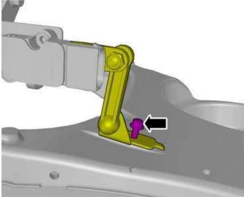
**17. Die Schraube unten am Stoßdämpfer entfernen. Die Schraube muss vor dem Zusammenbau erneuert werden! / Remove the lower screw at the damper strut. This screw needs to be replaced against a new one at the assembly!**
