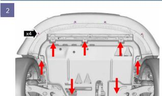
Die vier Schrauben der vorderen Unterbodenverkleidung lösen. Entfernen Sie auch die Motorverkleidung.
