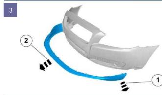
Ziehen Sie zunächst die äußeren Ecken des originalen Spoilers heraus. Anschließend ziehen Sie den Spoiler nach vorne heraus.
