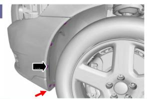
Entfernen Sie die beiden unteren Schrauben aus der Radhausverkleidung bzw. aus dem Spoiler.
