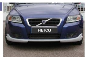
Montieren Sie den Frontspoiler mit 2 Personen wie auf dem Bild zu sehen. Achten Sie darauf dass die beiden Stehbolzen durch die aufgeweiteten Clipaufnahmen geschoben werden. Überprüfen Sie die Passungen und übergeben Sie anschließend den Frontspoiler zu einem Lackierfachbetrieb.
